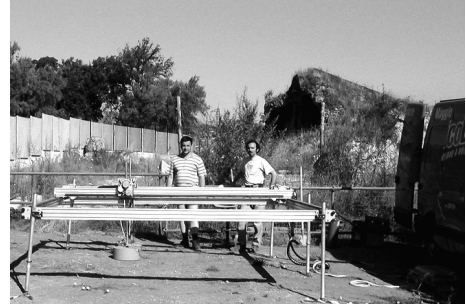
Fig. 2 - Immagine dello strumento: in primo piano c'è il sistema di posizionamento con sopra le antenne, il rack è a bordo del furgone sulla destra.
