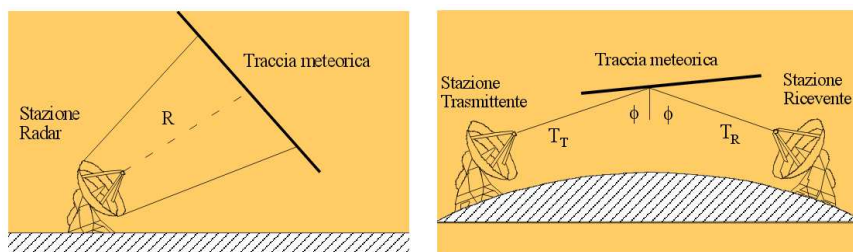
Figura 3: Radar meteorici di tipo monostatico (a backscatter ) e bistatico (a forward scatter ) che utilizzano tracce meteoriche ionizzate come bersaglio.
