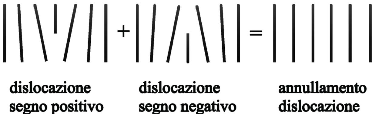
Figura 2.49: Schema dell'annullamento di due dislocazioni a spigolo di segno opposto
