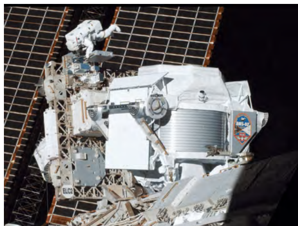
Figura 8: Telescopio per raggi cosmici AMS02, durante la sua installazione sulla International Space Station (ISS).
