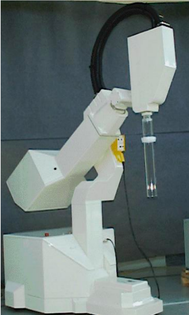
Figura 3: LINAC di elettroni dedicato alla IORT.
