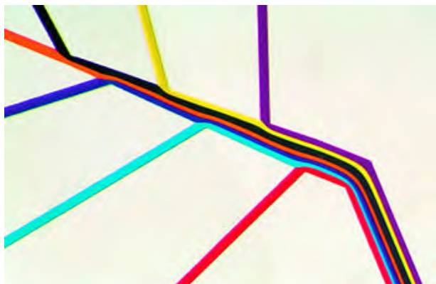
Figura 5: Regime laminare in un dispositivo microfluidico. I flussi colorati provenienti dai diversi canali non si intersecano ed i loro percorsi sono predicibili. Adattata da [21].
