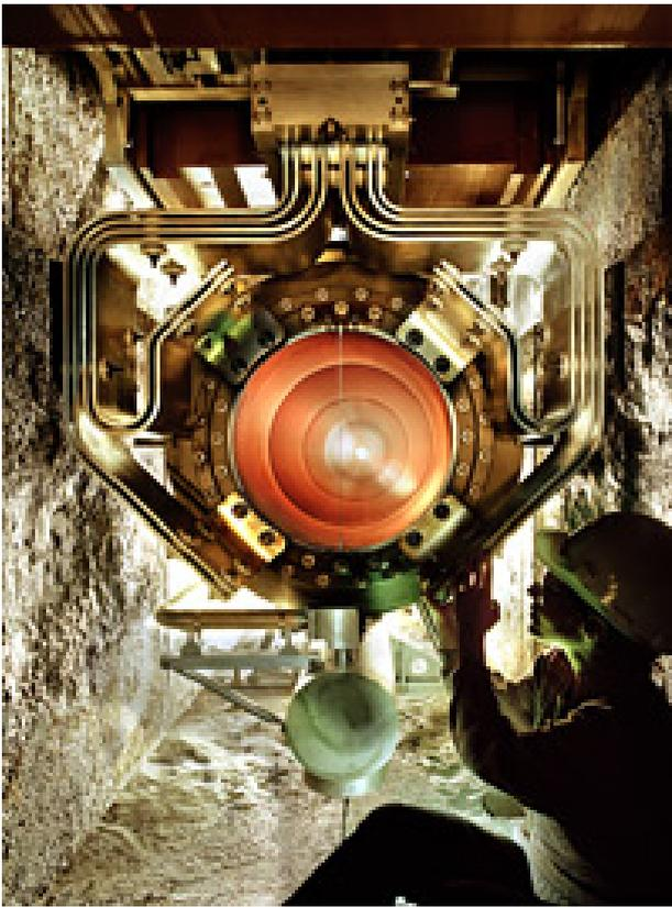
**Figura 1:** Fotografia del bersaglio per neutrini usato in NuMI. Foto cortesia di Fermilab.
